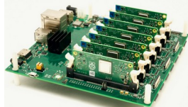
Compute Module クラスターにより スパコン等高性能コンピュータに
